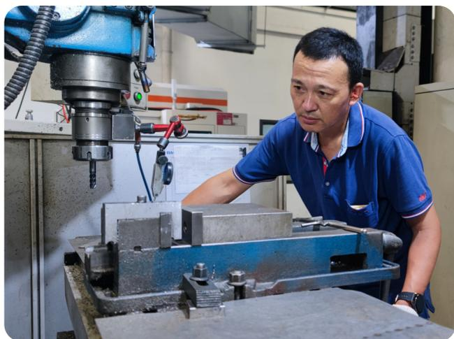
条，一拃长两指宽，轻轻地抵在转动冲头前端，我懂了，这是一个手动跟刀架，目的是防止加工过程中工件回弹，磨成锥头冲了，看得出来木条已用了很久，因为前端有磨损形成的小圆槽。工装组很多小件需要点孔，老周就充分利用工具铣设备精度高、操纵便利的特点，加工零件。为提升工作质量和效率，爱思考的老周在精密平口钳上做了一个快捷定位，东西虽小，让我叹服，装夹时工件往定位一靠，就是零点，再配合设备数显数据，移动工作台到正确位置，然后点孔刀下移点孔，既快又准，零件都不
